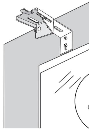
Instale el segundo perno a través del orificio posterior si el soporte cuenta con uno. De lo contrario, un perno simple sostendrá el soporte en forma segura.
