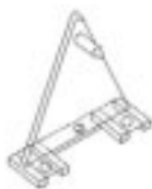
Crochet de porte/retenu (pour maintenir le rail du bas en place – ex. : installation sur une porte avec fenêtre)
