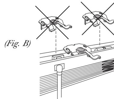
2. Vissez le support en vous servant des deux vis prévues à cet effet. Laissez le levier pivotant à la position ouverte.
