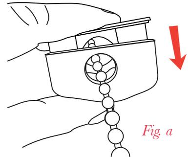
1. Compresser le dispositif de sécurité et ensuite le glisser au bas de la chaîne (fig a).
