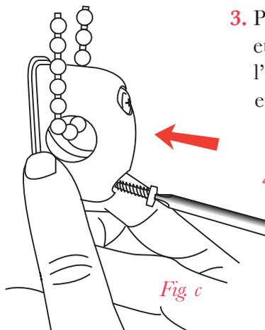
3. Placer la base du dispositif à l'endroit où vous désirez l'installer et compressez celui-ci. Vissez les vis qui vous sont fournies à l'aide d'un tournevis pour maintenir le dispositif comprimé bien en place (fig c).
