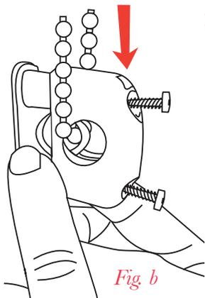
2. Insérer un vis 2" dans chaque trou. Ce dispositif peut être posé sur le cadrage ou au mur. Tirez le dispositif de tension vers le bas jusqu'à ce que la chaîne soit bien tendue des deux côtés (fig b).
